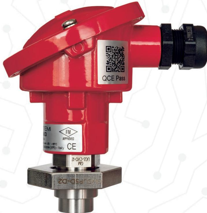
Il rivelatore di fiamma GMFD005D è un dispositivo elettronico in grado di misurare l'intensità della radiazione infrarossa emessa da qualunque tipo di fiamma. Uno speciale filtro ottico, consente di minimizzare gli effetti di sorgenti luminose, quali il sole, le lampade fluorescenti e la luce ambientale.
