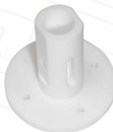
GMTRB-FX2-IS SUPPORTO ISOLATO IN "POM-C" Si consiglia l'uso per steli di lunghezza maggiore di 850mm. Temperatura massima di utilizzo in continuo per 5000 ore +110°C
